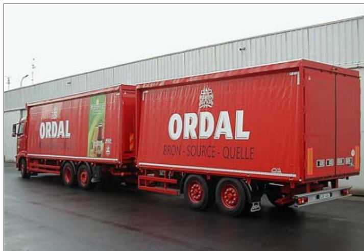
Ook opbouwen met oprulbare zeilen, specifiek voor het transport van dranken, worden door de firma uit Erpe-Mere geconstrueerd
