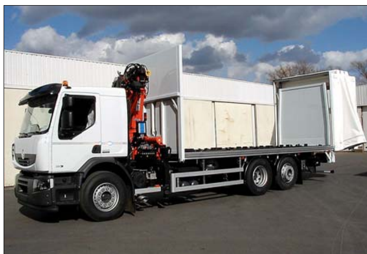
Speciale opbouwen, zoals hier bij deze vrachtwagen met volledig openschuivende huif, zijn ook mogelijk
